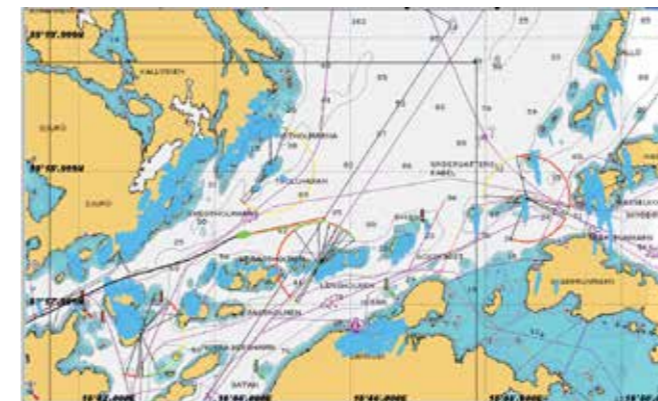
Bild 1 Vi befinner oss i den gröna båten till vänster i bilden. Vid pilen finns fyren Gastholmsgrund som är en smal "betongpinne" mitt i vattnet. Det blåa strecket är ekot av fyren. Ekot är mycket bredare än det verkliga föremålet.
