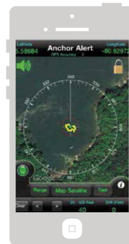
Anchor Alert (28 kronor, 2,4 Mb) är ett litet program som med hjälp av den inbyggda GPS:en kan ställas in för att varna om båten draggar eller vinden vänder när du ligger på svaj. Ljud- eller vibrationslarm. Med ett grafiskt gränssnitt kan du se din ändrade position som flygbild.
